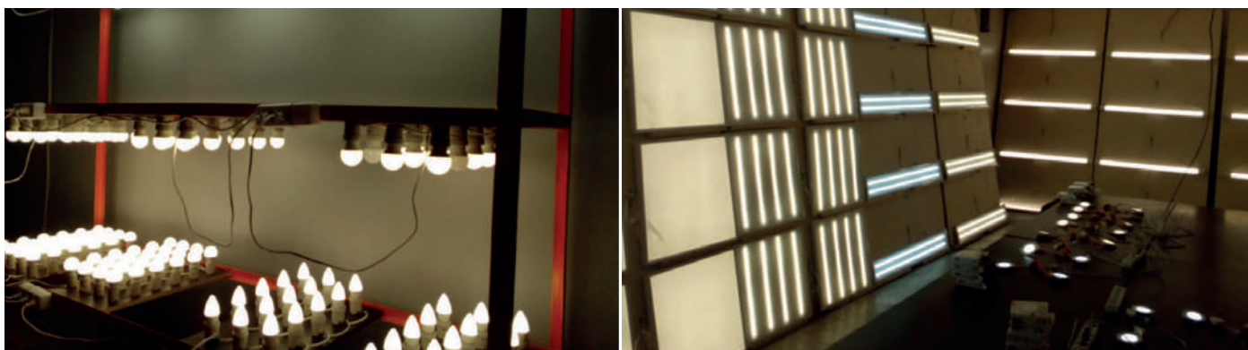
Стенды проверки светильников и ламп
