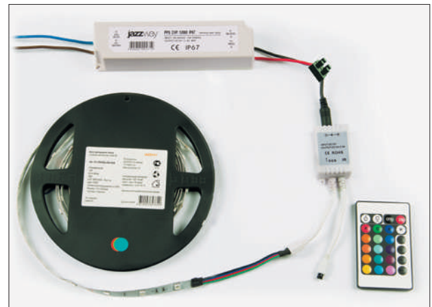
Пример подключения светодиодной ленты с контроллером RGB 1000RC
